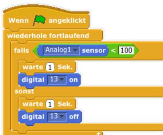
Dafür benötigt man eine Verzweigung (IF-Bedingung) die in Scratch mit *>falls<* eingeleitet wird. Der Lichtsensor wurde am Analog1 eingesteckt. Sollte dieser unter 100 fallen werden die Anweisungen ausgeführt. Der gesamte Code ist in eine Endlosschleife eingebettet.
