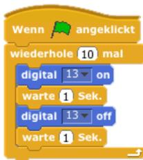
Darauf aufbauend wurde der erste Algorithmus aufgearbeitet. Ein Programm, welches das LED ein und ausschaltet und dazwischen den jeweiligen Zustand für eine Sekunde belässt. Anspruchsvoller ist hier die Zählschleife. Der Vorgang wurde 10mal wiederholt. Der dafür benötigte Code wird in Scratch wie in der Abbildung links dargestellt.
